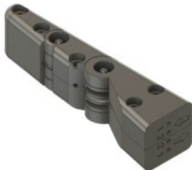
Mechanika úchopného prvku antropomorfního typu chápadla (Martin Schönbauer, 2025)
